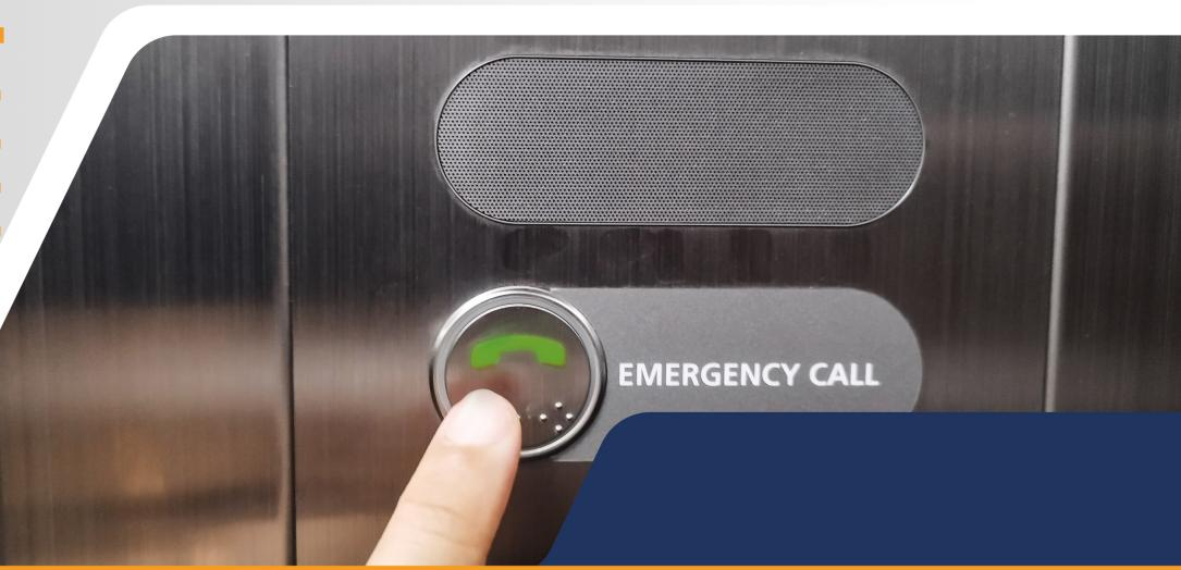
برای نصب این دستگاه در داخل کابین آسانسور، فقط کافی است از یک کلید احضار با شاخص تلفن اضطراری (تماس اضطراری) استفاده کنید و در صورت نیاز به برقراری ارتباط داخلی می‌توانید گوشی اینترکام را نیز به آن متصل کنید.
